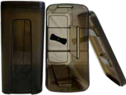
**Waschbehälter/Deckel:** Die VeriWHIRL ist mit zwei separaten herausnehmbaren Waschbehältern ausgestattet, die jeweils bis zu 3 Liter Isopropanol fassen. Ein Waschbehälter dient für die erste Reinigung, der zweite für das zweite (frische) Bad. Beide Waschbehälter verfügen über einen separaten Deckel. Ein rotierendes Flügelrad am Boden der Behälter sorgt für die Zirkulation des Lösungsmittels.
